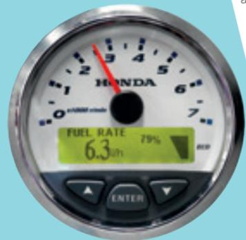
ECOmo (Contrôle du mélange pauvre), permet de réduire la consommation en carburant en optimisant le ratio air/essence.
