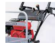
La transmission hydrostatique offre une grande facilité d'utilisation
