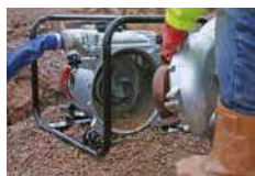
La trappe de visite amovible permet un accès rapide
