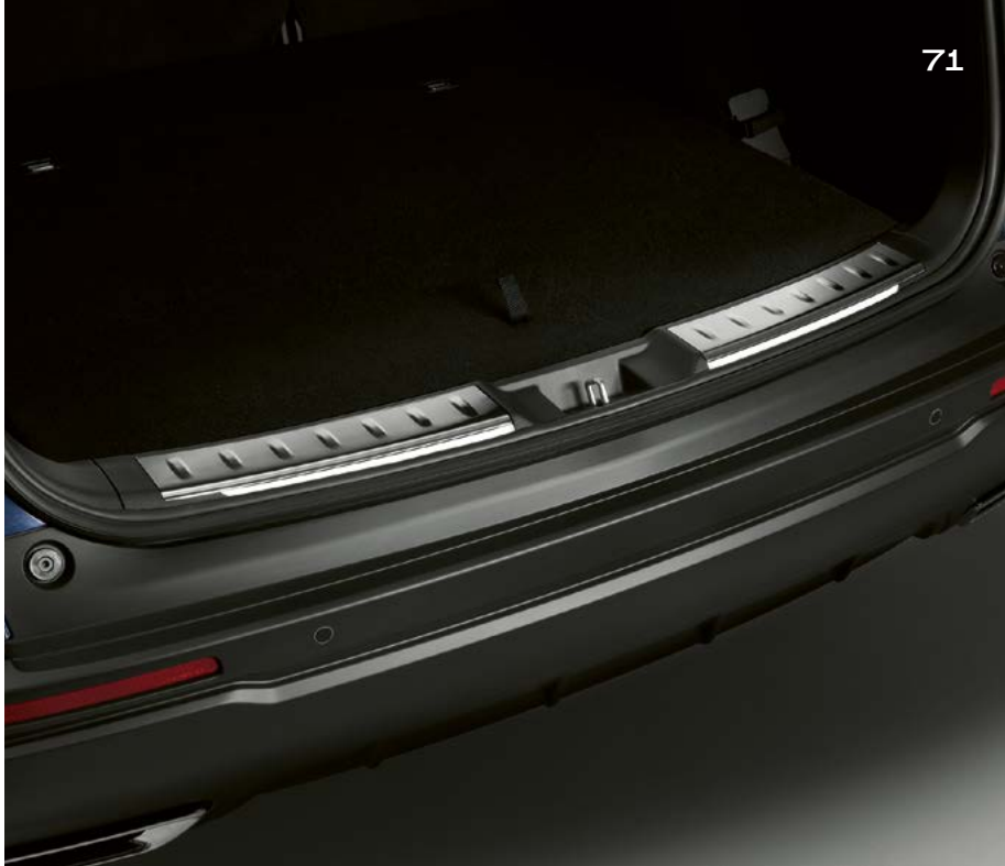
DÉCORATIONS DE SEUIL DE CHARGEMENT ILLUMINÉES Protégez le seuil de coffre en installant cette garniture de seuil de coffre en acier inoxydable. Elles s'allument lors de l'ouverture du couvercle du coffre pour améliorer la visibilité de nuit.
