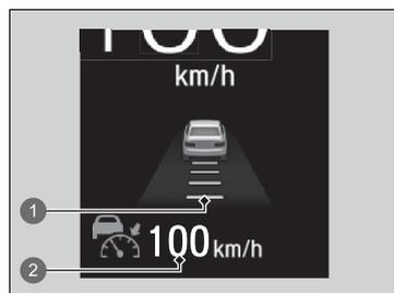
Lorsque l'ACC avec maintien de distance de sécurité à basse vitesse démarre, l'icône du véhicule, les barres d'intervalle et la vitesse réglée s'affichent sur la jauge.
