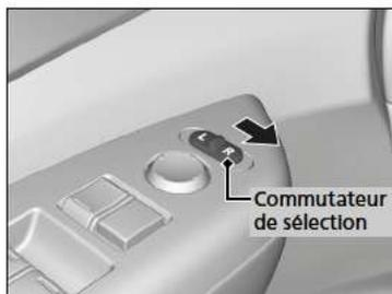
S'il est activé, le rétroviseur côté passager s'incline automatiquement lorsque le levier de vitesses passe en position **R**; ceci améliore la visibilité côté passager du véhicule lors d'une marche arrière. Le rétroviseur revient automatiquement sur sa position d'origine lorsque l'on désengage la position **R**.
