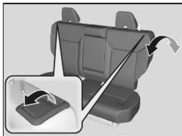
Tirer le levier situé sur la droite pour modifier l'angle de la partie droite des sièges arrière, et le levier situé à gauche pour la partie gauche.
