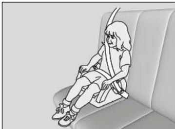
Si l'utilisation d'une ceinture ventrale/thoracique ne convient pas, placer l'enfant dans un siège rehausseur sur l'un des sièges arrière. Pour la sécurité de l'enfant, s'assurer que ce dernier satisfait à l'ensemble des conditions du fabricant du siège rehausseur.
