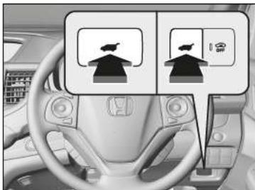
Ouverture : Maintenir enfoncé le bouton du hayon situé sur le tableau de commande du côté conducteur pendant une seconde environ.
