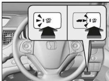
Pour désactiver le système de capteurs à ultrasons, appuyer sur la touche OFF du capteur à ultrasons après avoir retiré la clé du contacteur d'allumage, ou avec la clé en position ACCESSOIRES **I** ou ANTIVOL **0**\*1.
