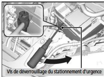
4. Insérer un tournevis dans le trou dans l'axe de la vis de déverrouillage du stationnement.
