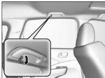
Des crochets porte-manteau sont montés sur les poignées de maintien arrière gauche et droite. Les faire sortir en les tirant vers le bas pour les utiliser.
