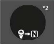
*2 | <ul style="list-style-type: none"> <li>S'affiche lorsque vous déplacez le levier de vitesses de la position <b>N</b> à n'importe quelle autre position sans appuyer sur la pédale d'embrayage alors que l'arrêt au ralenti automatique est en fonctionnement.</li> </ul>
