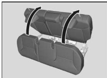
■ **Pour remettre le siège dans sa position d'origine**
