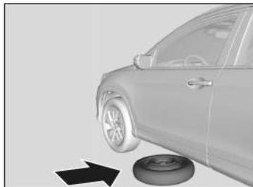
6. Placer la roue de secours (côté voile de jante dirigé vers le haut) sous la caisse du véhicule, près de la roue à remplacer.
