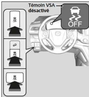
Ce bouton se trouve sur le panneau de commandes côté conducteur. Pour activer et désactiver partiellement le système VSA, appuyer sur le bouton et le maintenir enfoncé jusqu'à ce qu'un signal sonore retentisse.
