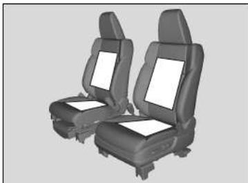
Pour pouvoir utiliser le chauffage de siège, le contacteur d'allumage doit être sur MARCHE **II**\*1. Le réglage **HI** chauffe les sièges plus rapidement que le réglage **LO**.
