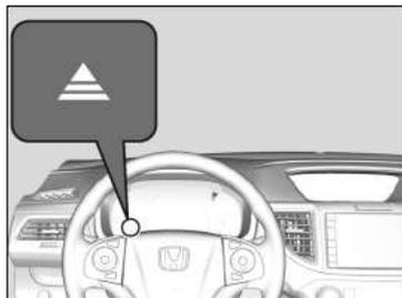
S'allume lorsque le véhicule est en mode de changement de vitesse séquentiel, pour indiquer quand il faut changer de vitesse pour minimiser la consommation de carburant.
