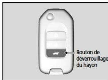
Appuyer sur le bouton de déverrouillage du hayon pour déverrouiller le hayon.
